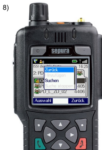
8) "Ordner verlassen" auswählen, Kontext-Taste links betätigen, "Zurück" auswählen und mit Kontext-Taste links bestätigen, danach 2x die rechte Kontext-Taste betätigen
